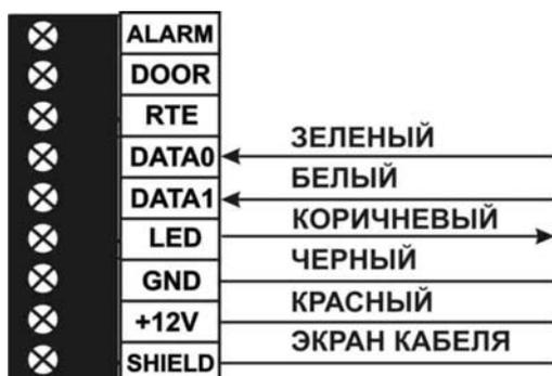
На рисунке 4 представлено типичное подключение считывателя к порту панели. Цвета проводов необходимо уточнить для считывателя конкретного производителя.
